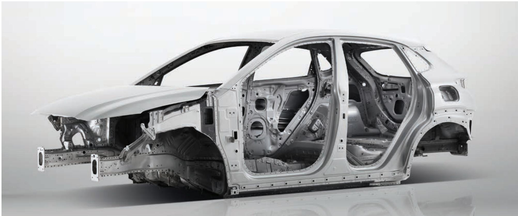
La estructura de la cabina está diseñada para dispersar la energía en caso de colisión, reduciendo así el impacto a los ocupantes
