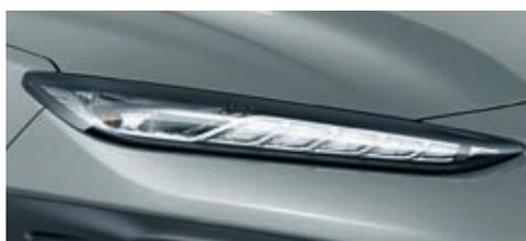
Luces de conducción diurna tipo LED
